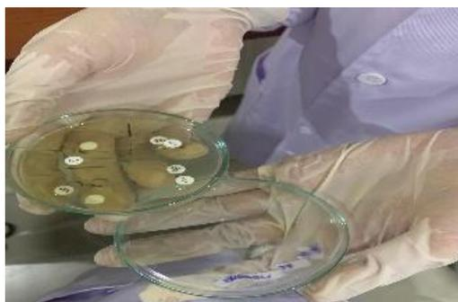
**Gambar 5.** Peletakan blank disk untuk uji aktivitas antibakteri
