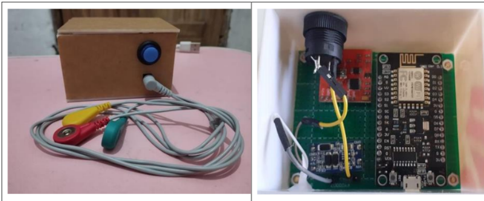
Gambar 9. (a) Tampilan alat EMG dari depan (b) Bagian dalam alat
