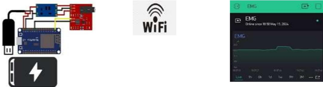
**Gambar 6.** Rancangan Prototipe EMG portabel
