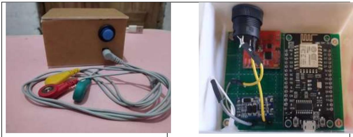
**Gambar 9.** (a) Tampilan alat EMG dari depan (b) Bagian dalam alat
